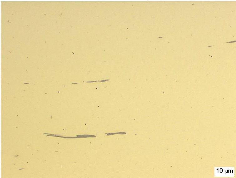
**Bild 5-3** Probe aus C45, in Wasser gehärtet, mechanisch geschliffen und mechanisch poliert (00AF\_00188)
