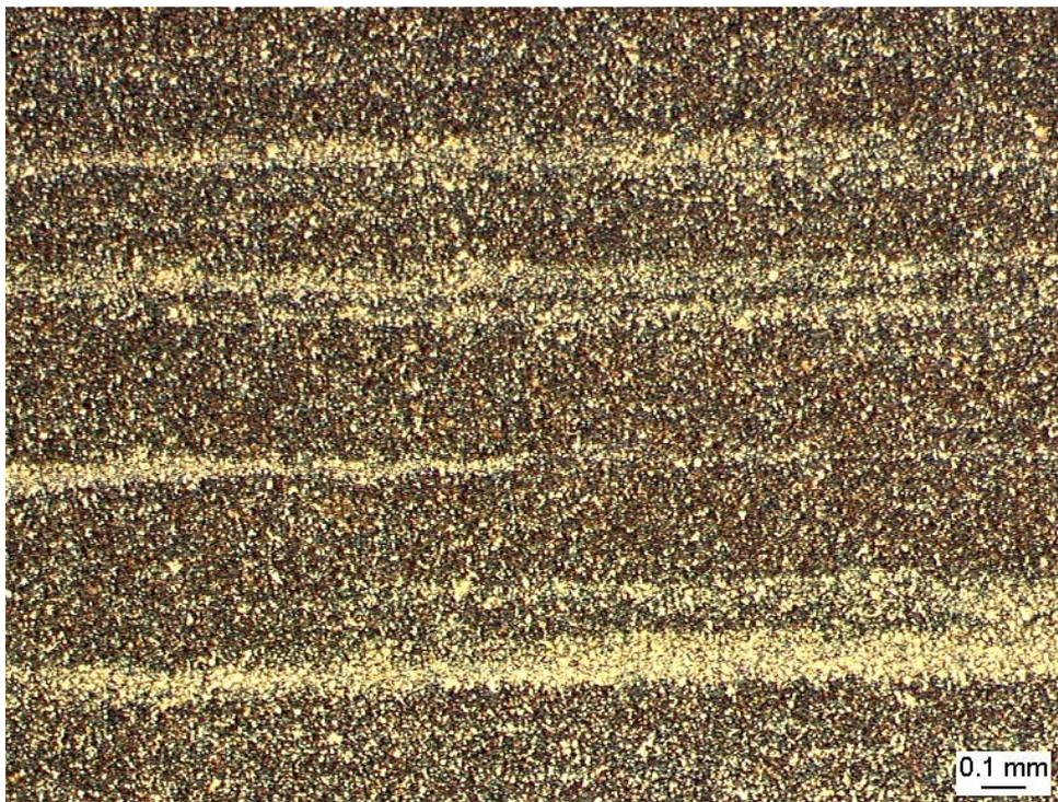
**Bild 5-1** Gefügebild eines C45 mit ausgeprägter Zeiligkeit (00AF\_00695)
