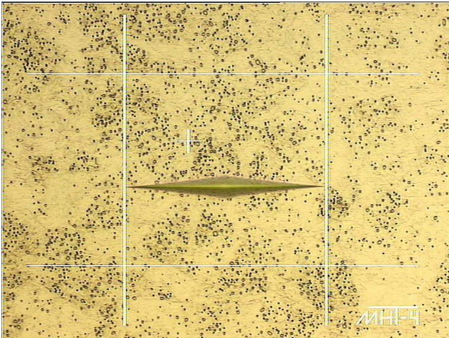
**Bild 3-7** Gefügebild eines 100Cr6 mit Härteeindruck nach Knoop und Einblendung der Linien zum Ausmessen des Abdrucks am MHT-4 (00AF\_00684)
