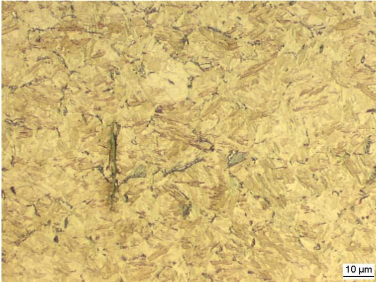
**Bild 5-5** Probe aus C45, in Wasser gehärtet, mechanisch geschliffen und elektrolytisch poliert, nicht geätzt, starker Angriff des Gefüges beim Polieren (00AF\_00229)
