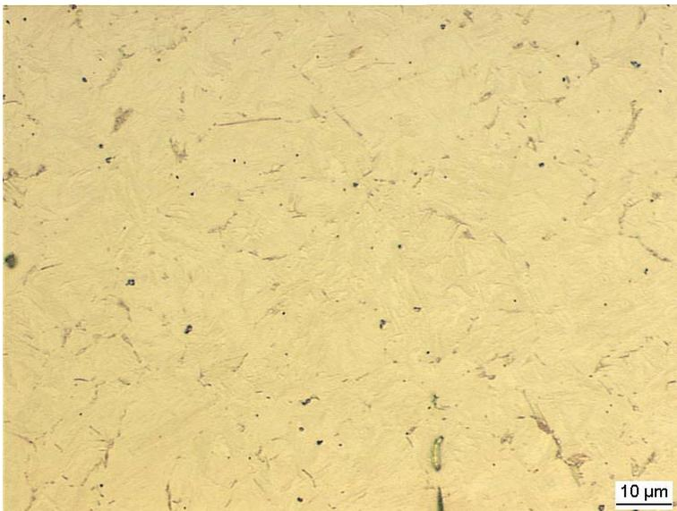
**Bild 5-4** Probe aus C45, in Wasser gehärtet, mechanisch geschliffen und elektrolytisch poliert (00AF\_00108)
